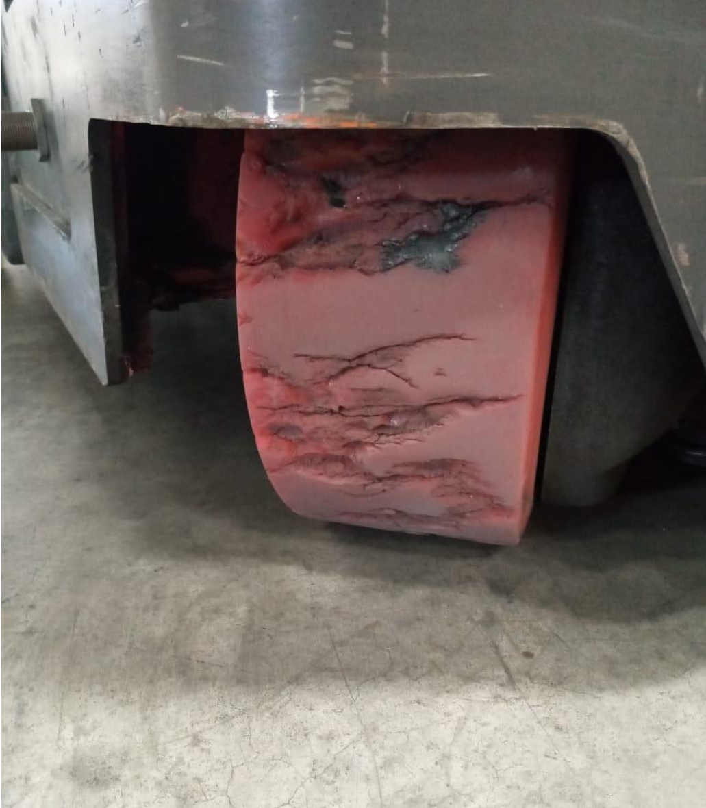
Ilustración 36: Falta de MPP a Maquinarias
