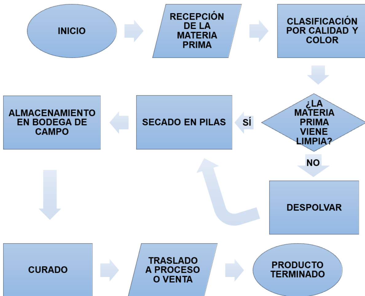
Gráfico 6. Diagrama de Flujo del proceso de secado.
