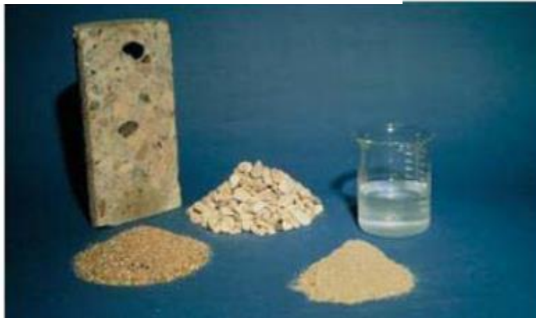
Componentes del Concreto.
