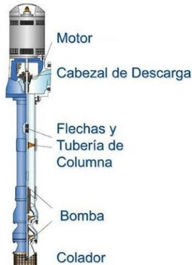
Figura 3: Esquema bomba vertical.
