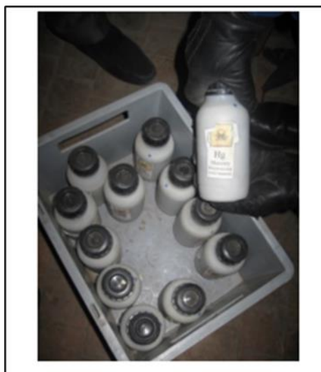
Figura 21. Contenedores de acero para el almacenamiento del mercurio
