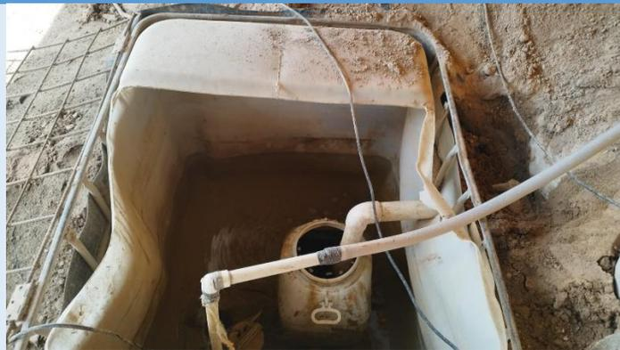
**Depósito de carbón para la absorción de oro en solución**
