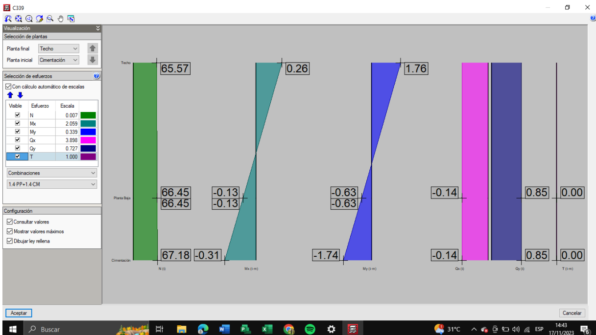
Imagen 32 Análisis de esfuerzos en columnas
