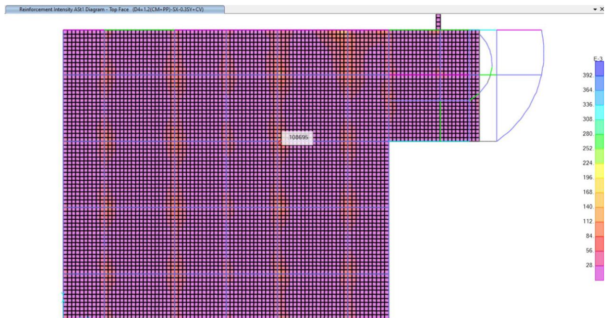
Figura 80 Análisis de losa de entrepiso
