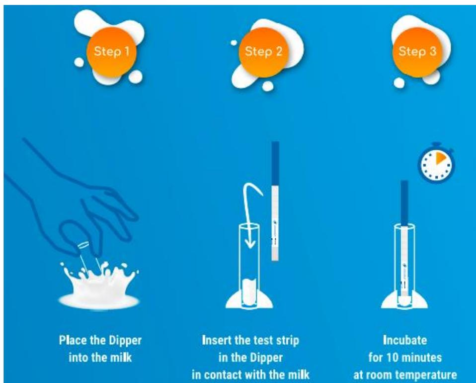
*Nota:* La prueba cuenta con tres pasos, primero se sumerge el tubo colector dentro de la muestra, segundo se coloca la tira reactiva dentro del tubo colector, tercer paso esperar 10 min a temperatura ambiente para conocer los resultados.
