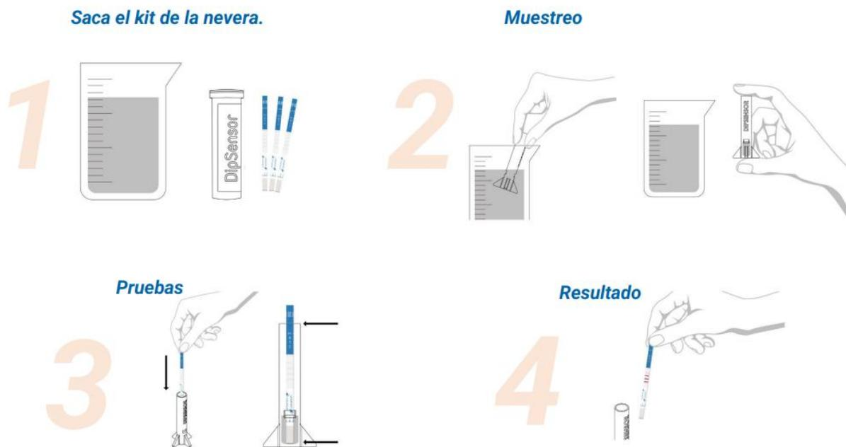
*Nota:* En la figura se describe el paso a paso del uso del kit Dipsensor.
