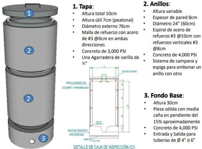
Figura 4 Pozo de visita.
