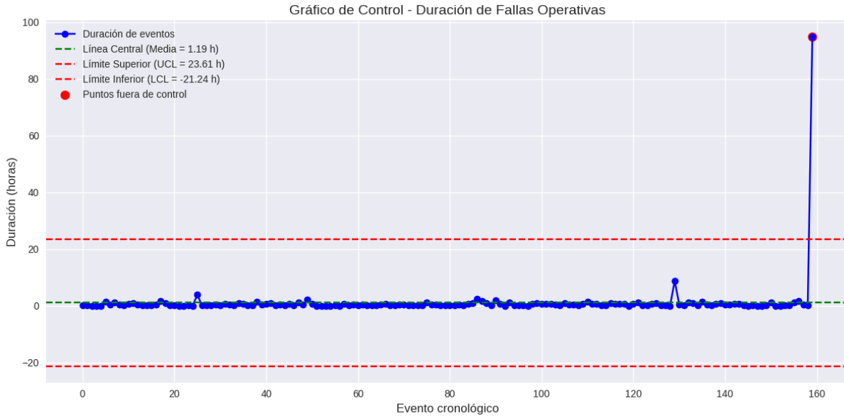
Figura 14 Gráfico de Control – Duración de Fallas Operativas
