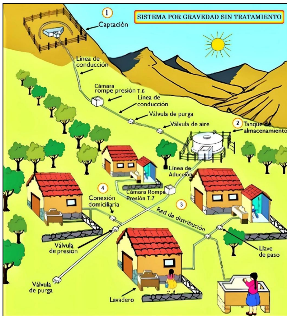
Sistema de Abastecimiento por Gravedad
